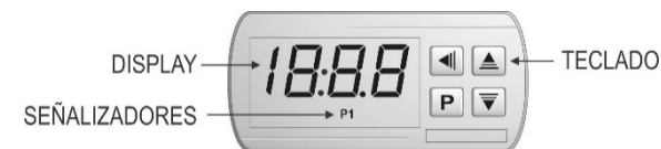
Fig. 05 – Panel frontal del controlador
