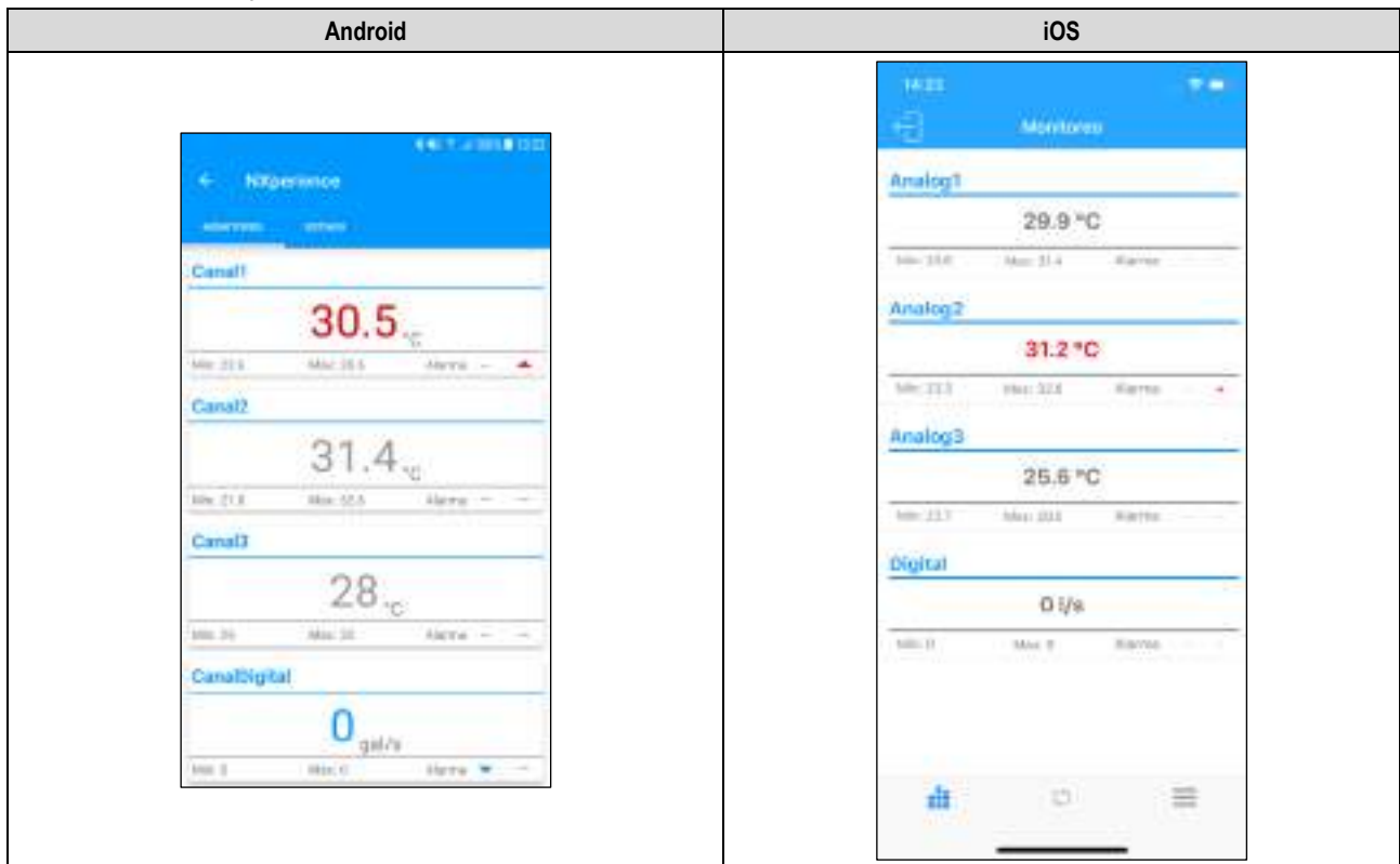
Figura 35 – Monitoreo: Alarma de Alta
