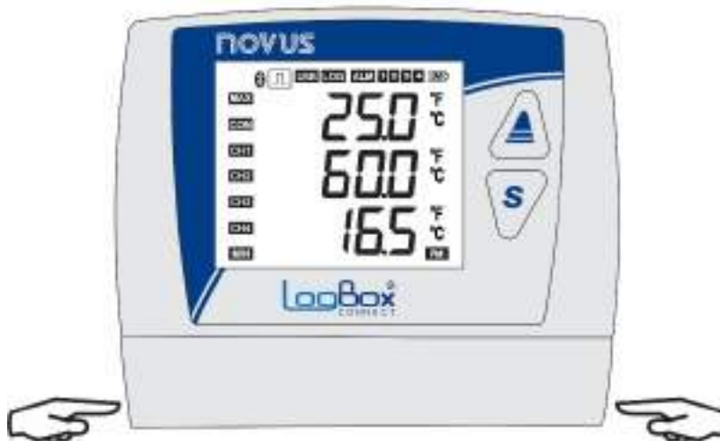
Figura 46 – Desencaje de la tapa de protección
