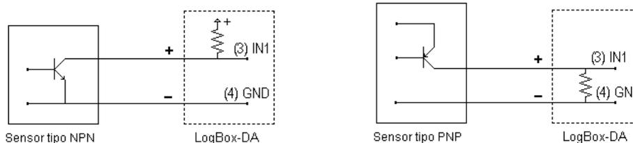
Fig. 11 – Entrada Colector Abierto NPN y PNP para el canal 1
