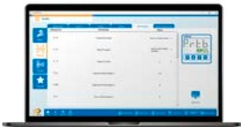
Ciertas aplicaciones requieren una tarea aburrida, que es replicar la configuración de muchos dispositivos en el banco de trabajo. La configuración en lote proporciona el entorno apropiado para definir la configuración del dispositivo y replicar en secuencia cuando se conecta el dispositivo a través de USB.
