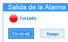
Figura 23 – Salida de alarma con forzamiento en estado encendido
