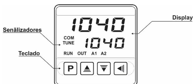
Figura 2 – Identificación de las partes del panel frontal
