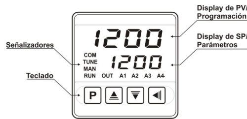
Figura 7 - Identificación de las partes del panel frontal
